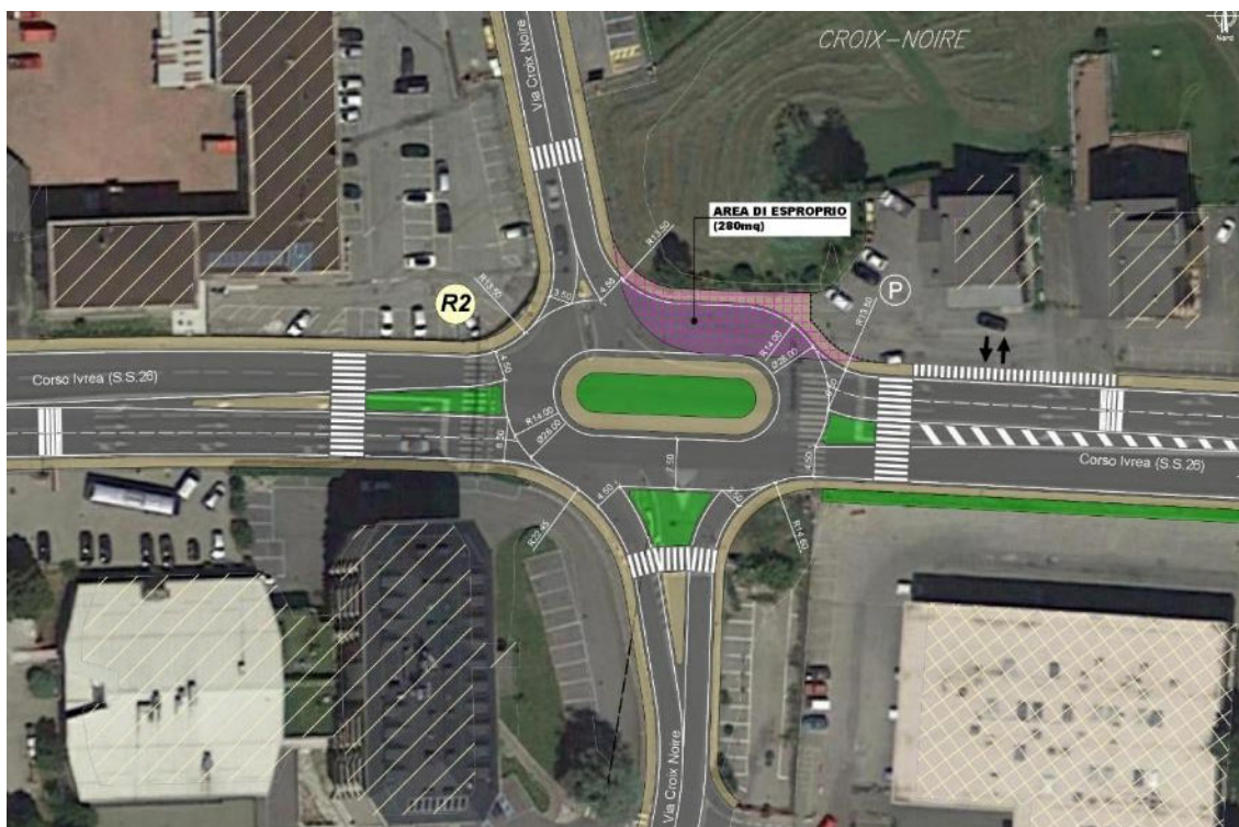
Intersezione tra Corso Ivrea e Via Croix Noire: INTERSEZIONE A SCHEMA ROTATORIO DI PROGETTO
