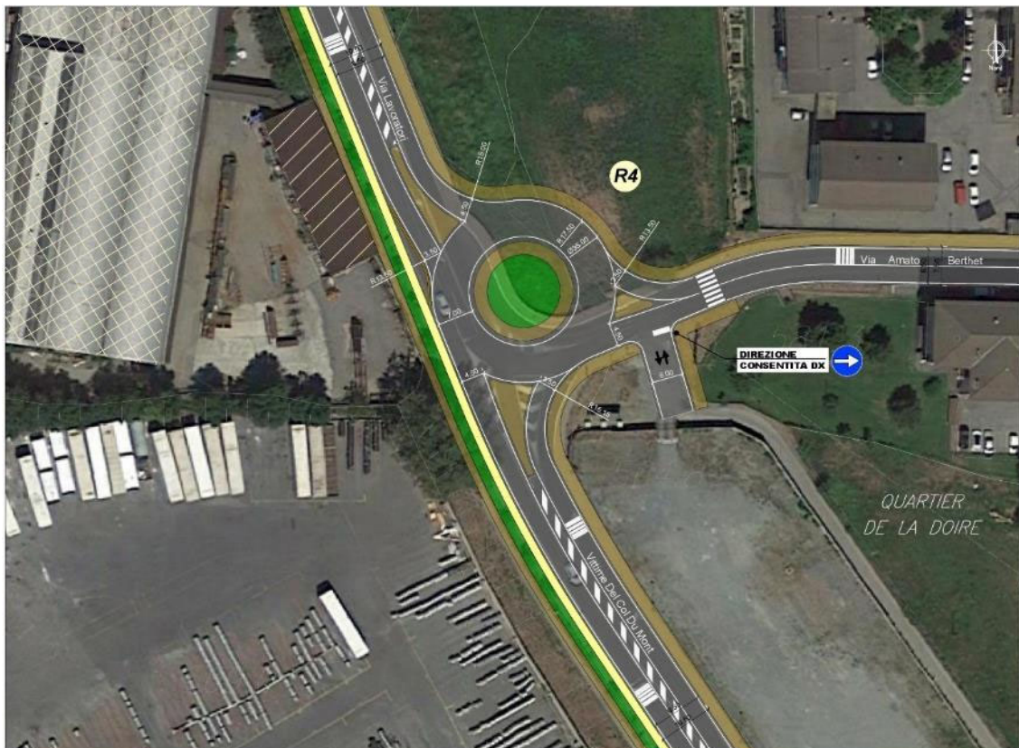
Intersezione tra via Lavoratori Vittime del Col du Mont e via Aimé Berthet: ROTATORIA DI PROGETTO
