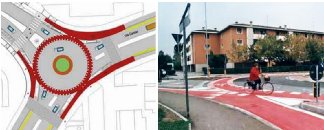
Rotatoria per ciclisti in anello (fonte: “Quaderni del Centro Studi FIAB Riccardo Gallimbeni”)
