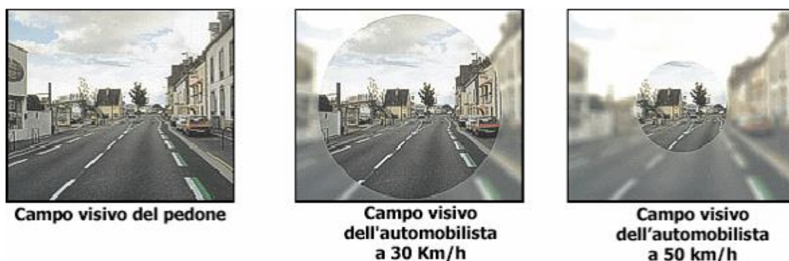
Figura 9-5: Comparazione del campo visivo a differenti velocità
