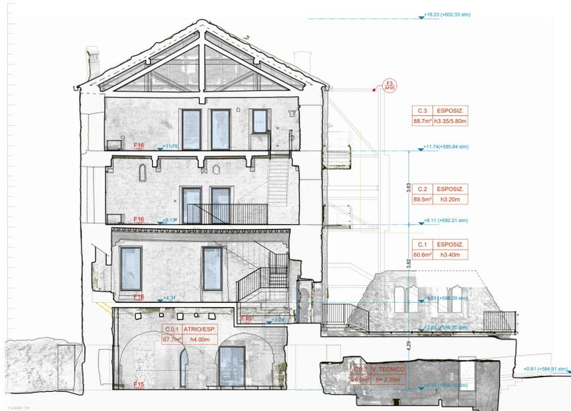
SEZIONE A / SOVRAPPOSIZIONE RILIEVO 3D
