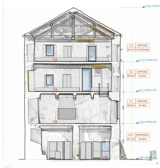
SEZIONE C / SOVRAPPOSIZIONE RILIEVO 3D
