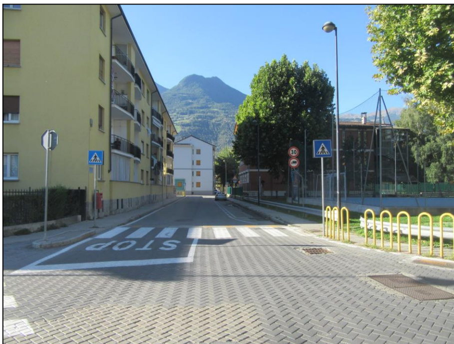
FOTO 07 VISTA FOTOGRAFICA VIA DORA BALTEA INCROCIO RIALZATO IN AUTOBLOCCANTI REGOLATO DA STOP CON VIA VALLI VALDOSTANE
