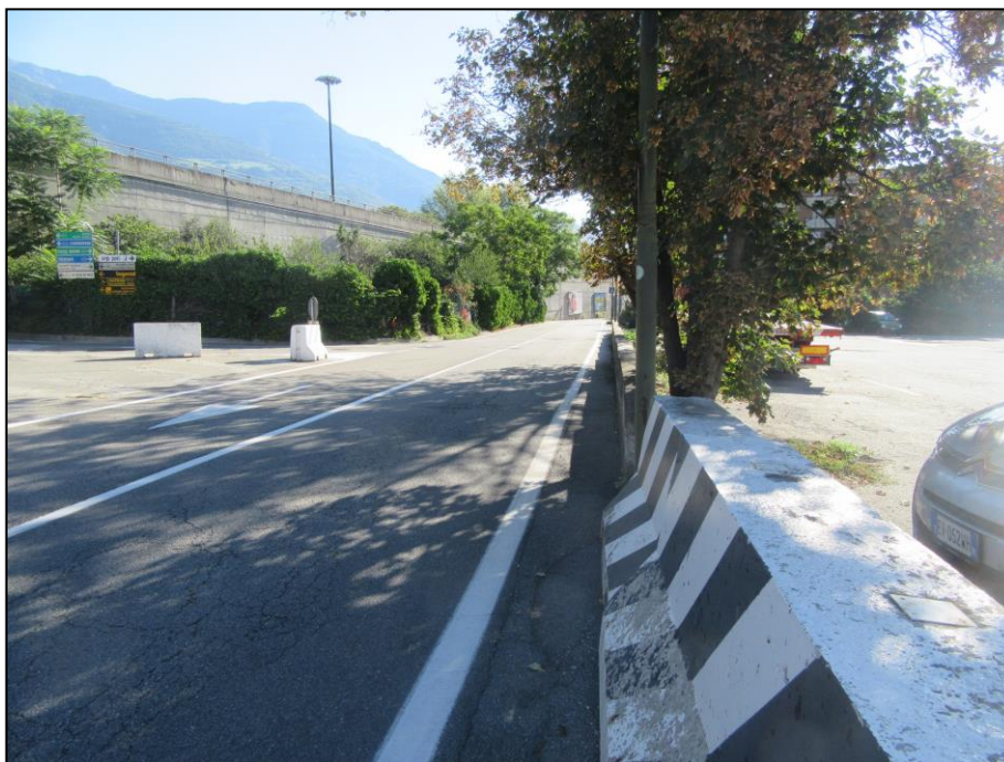
FOTO 41 VISTA FOTOGRAFICA VIA VALLI VALDOSTANE NEW JERSEY PER SEPARAZIONE CARREGGIATA CON L'AREA ASFALTATA DESTINATA A PARCHEGGIO
